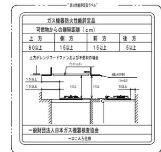
本機器は防火性能評定品であり、周囲に可燃物がある場合は防火性能評定品ラベル内容に従って設置してください。
