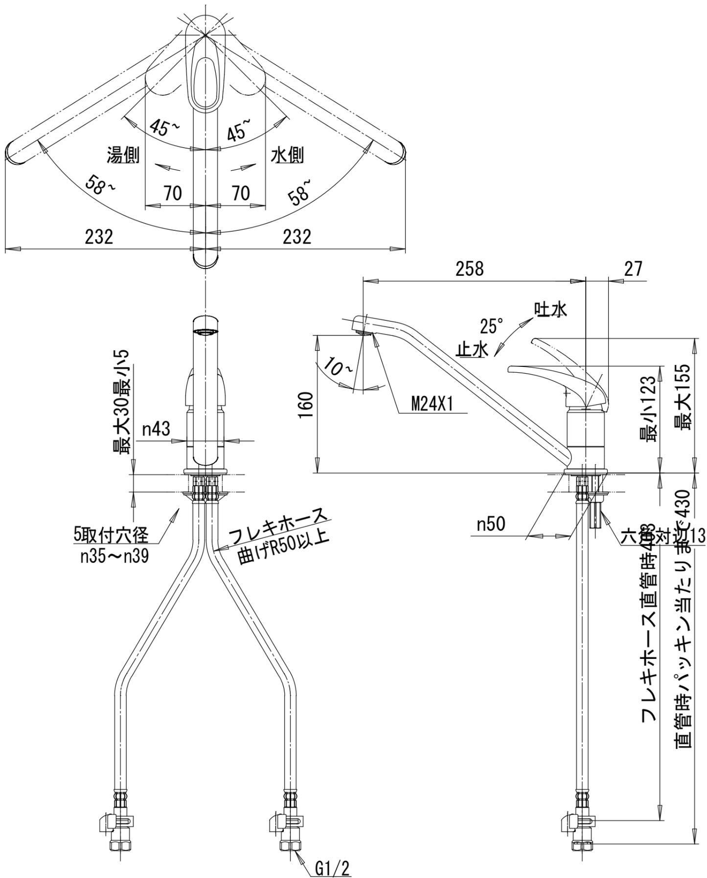
備考 JIS 上記寸法は推奨寸法ですので、現場状況に合わせて施工して下さい。 吐水口は回転式(116°)
